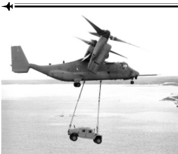
Рис. 3. Транспортировка автомобиля с помощью ВТС MV-22
