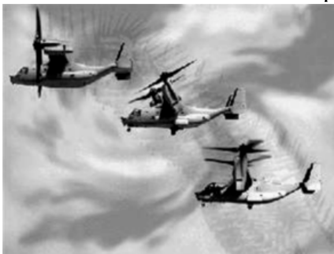
Рис. 2. Переход ВТС V-22 из вертолетного режима полета в самолетный
