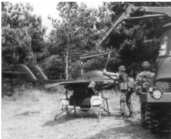
Рис. 2. Погрузка БЛА на пусковую установку подъемным краном
